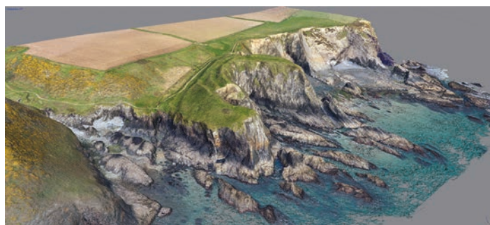
Model 3D o gaer bentir Porth y Rhaw y defnyddiwyd delweddaeth ddrôn ffotogrametrig i'w greu.
