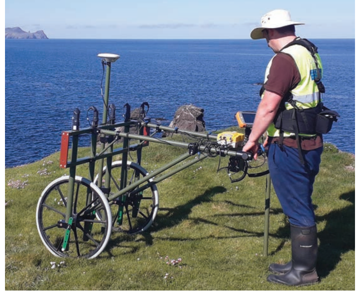
Llun o'n gradiomedr magnetig Sensys MXPDA newydd. Mae ganddo bum synhwyrdd wedi'u mowntio ar gert sy'n cynnwys GNSS ar gyfer lleoli'r darlenniadau.
