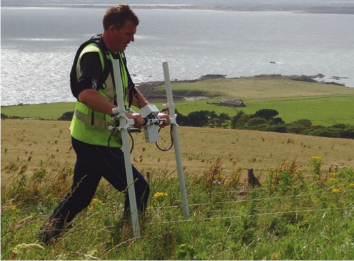
Rob Shaw yn gweithredu gradiomedr magnetig synhwyrdd-dwbl Bartington ar safle archaeolegol. Mae angen i grid gael ei osod allan ymlaen llaw drwy GPS cyn defnyddio'r ddyfais hon i wneud arolwg.
