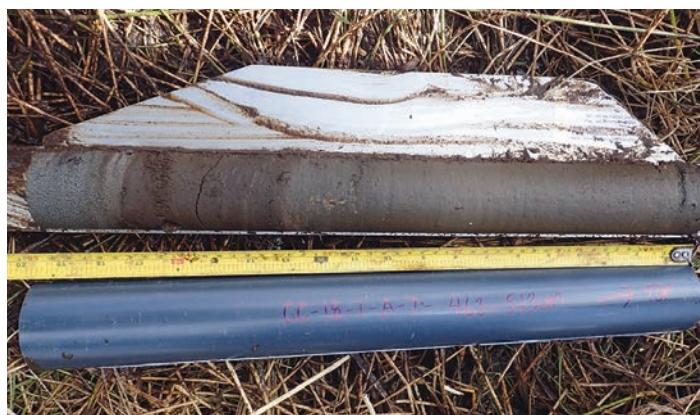
Sampl o ddyddodiad a gymerwyd gyda chreiddiwr Rwsiaidd o Gors Castellmartin, Sir Benfro. Cymerwyd y sampl hwn o tua 5 metr islaw arwyneb y tir.
