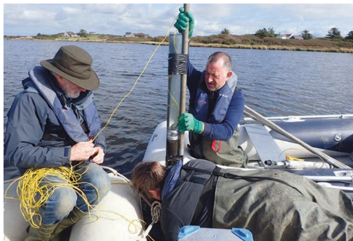
Cymryd craidd o ddyddodion arwyneb o Llyn Maelog. Retrieving a surface sediment core from Llyn Maelog.
