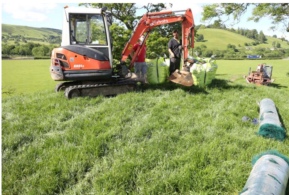
Kubota KX61-3, 2.6 tonnes, 360°, skid-steer mini excavator, IMG_7000, 23.06.2015
