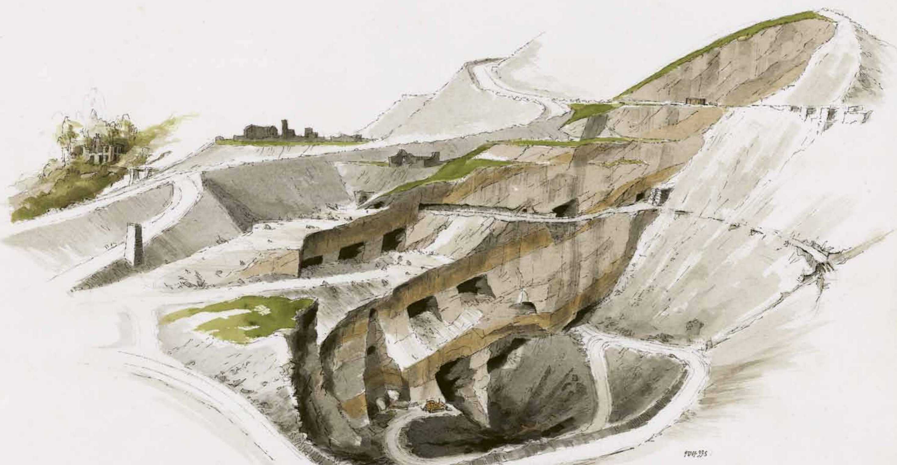
Siambrau yn y golwg: Chwarel Foty a Bowydd, 1977 Yn Chwarel Foty a Bowydd ger Blaenau Ffestiniog, câi'r llechfaen ei gloddio mewn siambrau mawr a ddilynai'r haenau o lechfaen a oedd ar olledd serth. Câi colofnau o graig eu gadael i gynnal y to. Mae gwaith mwy diweddar wedi cuddio'r rhan fwyaf ohonynt, ond yma mae'r to wedi'i dynnu i fwrdd i ddatgelu'r twnelau a siambrau tanddaearol.
